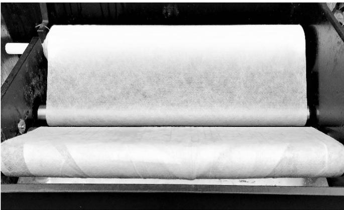
Verbinden Sie das Vlies mit der Hülse, indem Sie es 3 - 4 Umdrehungen auf die RoL-X Hülse wickeln. Achten Sie darauf, dass die Bremse der Filtertrommel nur leicht angezogen ist und sich diese noch leicht von Hand bewegen lässt. Setzen Sie nun die Hülse wie gewohnt ein.
