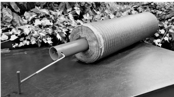
Ziehen Sie zuerst das Hülse teil der Antriebsseite des Filters aus der verbrauchten Rolle. Schieben Sie, wie auf dem Foto, den Haken von außen UNTER das verbrauchte Vlies. **Achten Sie unbedingt darauf, dass Sie hierbei kein Vlies einhaken oder einklemmen.**
