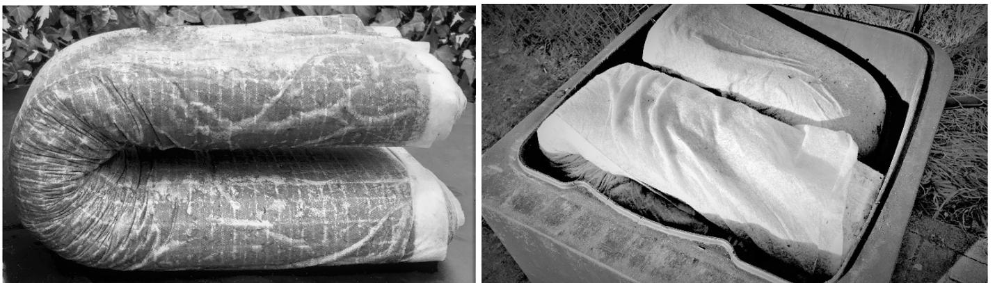
\*Wie die meisten Filterhersteller empfehlen wir, dass verbrauchte Vlies spätestens nach der Hälfte der Rollenlänge zu entfernen. Hierdurch wird der Filter entlastet, das verbrauchte Vlies lässt sich leichter entsorgen und beim Rollenwechsel ist deutlich weniger Kraftaufwand erforderlich
